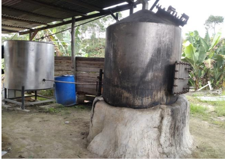
Gambar 4.2 Alat penyulingan serai wangi CV Lewis Pea Abadi
