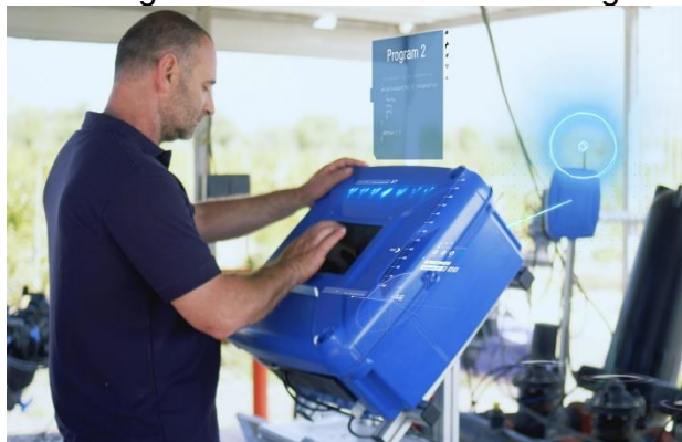
Gambar 4.1. Pengendalian Irigasi Dengan Menggunakan Netbeat
